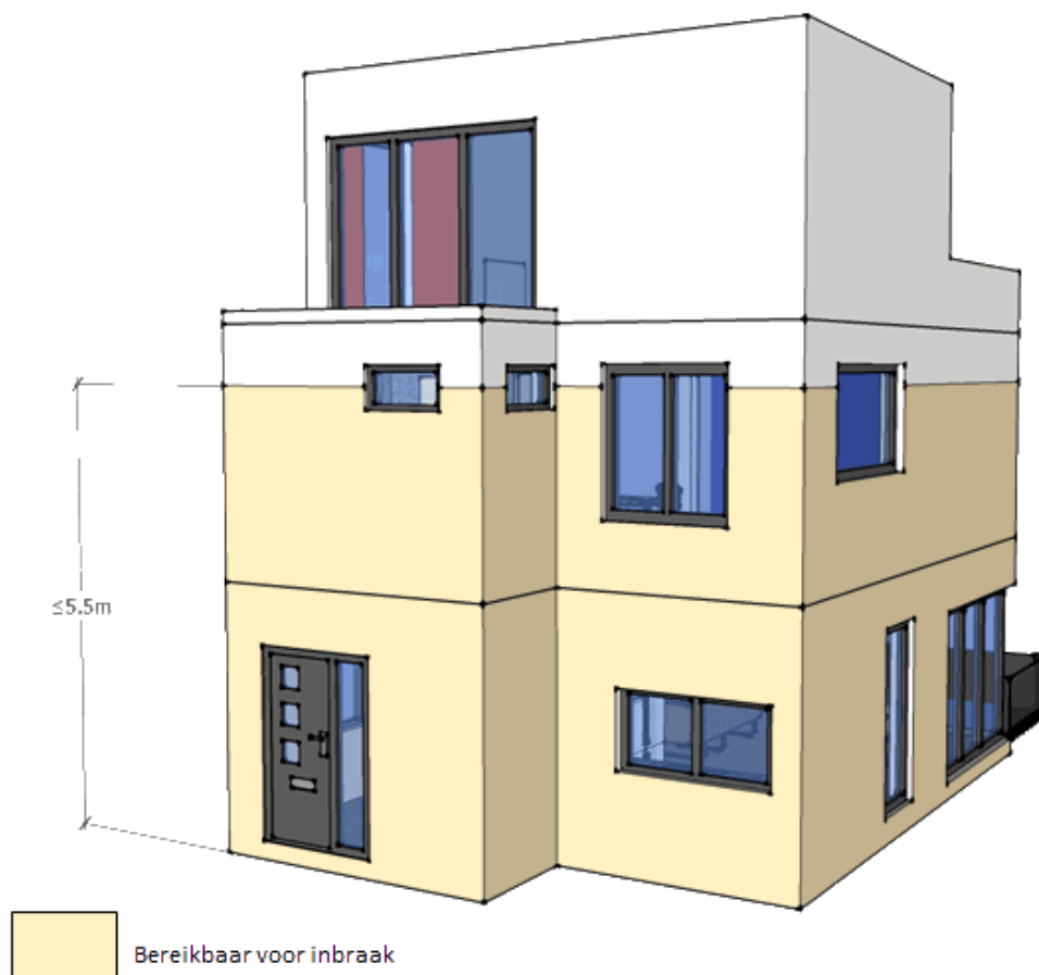
Figuur 1 Bereikbaarheid voor inbraak in de uitwendige scheidingsconstructie (bron: NEN 5087:2013)
